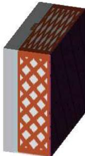
**$\Sigma\Delta OI3$**  36,8 Punkte/m<sup>2</sup>**EI<sub>kon</sub>** 0,0 Punkte/m<sup>2</sup>**Masse** 15,0 kg/m<sup>2</sup>**PENRT** 350 MJ/m<sup>2</sup>**GWP100S** 25 kg CO2equ/m<sup>2</sup>**AP:** 0,158 kg SO2 equ/m<sup>2</sup>**Nutzungsdauer:** nicht berücksichtigt
