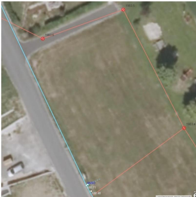
Lageplan Schmutzwasserkanal (rot) und Regenwasserkanal (blau, retentierte Einleitung mit max. 5 cm Querschnitt)
