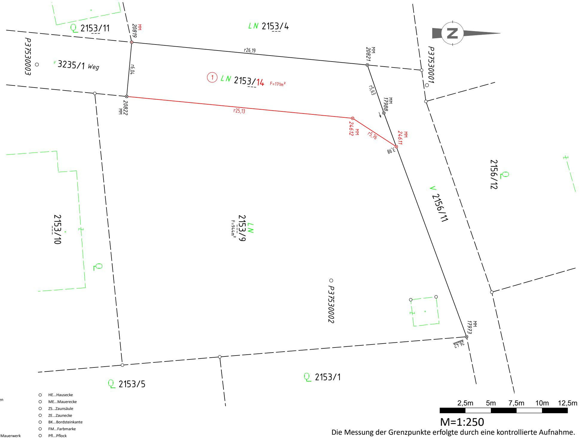
Die Messung der Grenzpunkte erfolgte durch eine kontrollierte Aufnahme.
